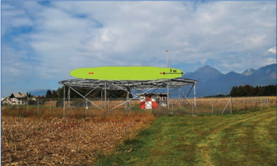
Slika 9: Efektivne vrednosti električne poljske jakosti v okolici VHF vsesmernega radijskega oddajnika v navpični ravnini skozi središče anten. Z rdečo barvo je prikazano vplivno območje za II. območje varstva pred sevanji, z zeleno pa za I. območje varstva pred sevanji.
