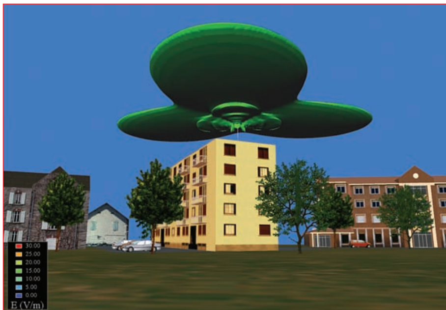
Slika 20: Vplivno območje bazne postaje z antenami nameščenimi na strehi stavbe. Prikazano je vplivno območje za I. območje varstva pred sevanji.
