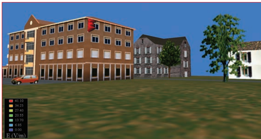
Slika 23: Vplivno območje bazne postaje z antenami nameščenimi na fasadi stavbe. Prikazano je vplivno območje za II. območje varstva pred sevanji.
