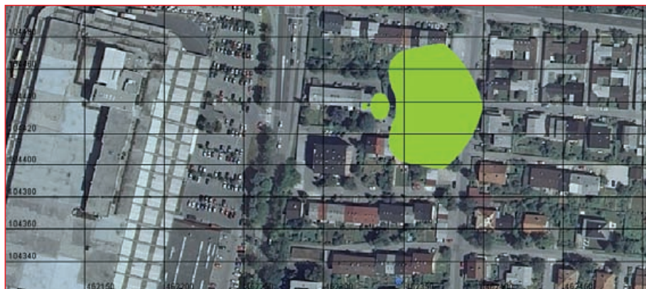
Slika 44: Vplivno območje radioamaterske postaje oddajne moči 1500 W na višini 25 metrov.
