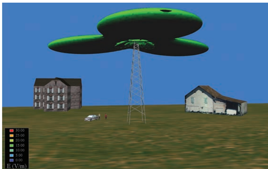
Slika 24: Vplivno območje bazne postaje z antenami nameščenimi na stolpu. Prikazano je vplivno območje za I. območje varstva pred sevanji.
