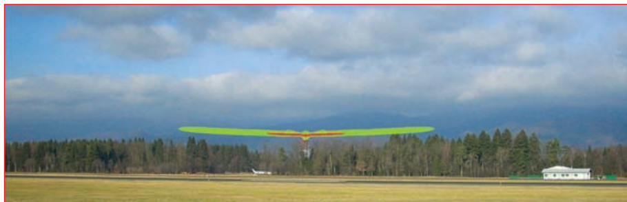
Slika 37: Vplivno območje radarja za nadzor zračnega prometa v navpični ravnini skozi središče radarja. Za I. območje varstva pred sevanji seže vplivno območje najdlje na višini 40 metrov nad tlemi, in sicer do 120 metrov daleč. Za II. območje varstva pred sevanji seže vplivno območje najdlje na višini 36 metrov nad tlemi in sicer do 40 metrov daleč.
