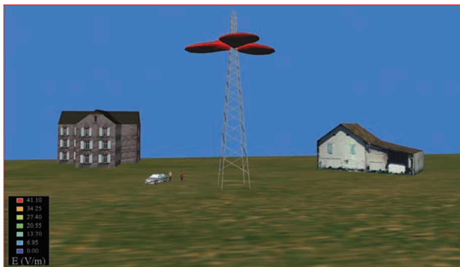
Slika 25: Vplivno območje bazne postaje z antenami nameščenimi na stolpu. Prikazano je vplivno območje za II. območje varstva pred sevanji.
