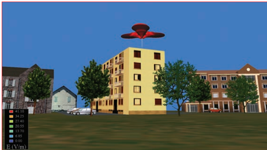
Slika 21: Vplivno območje bazne postaje z antenami nameščenimi na strehi stavbe. Prikazano je vplivno območje za II. območje varstva pred sevanji.
