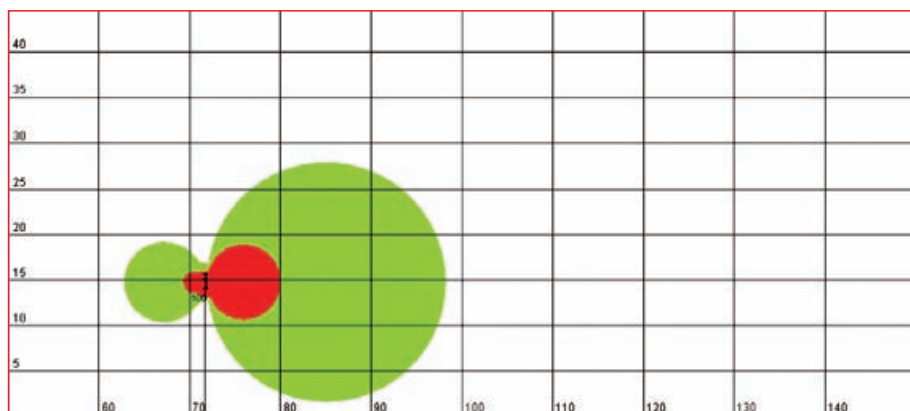
Slika 35: Vplivno območje radijskega oddajnika skupne oddajne moči 400 W za električno poljsko jakost v navpični ravnini, ki poteka skozi središče oddajnika. Največje vplivno območje za I. območje varstva pred sevanji je na višini 15 metrov nad tlemi in znaša 30 m. Za II. območje varstva pred sevanji znaša največje vplivno območje 10 m. Razdalje so podane v metrih.
