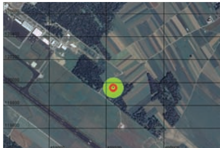
Slika 39: Vplivno območje radarja za nadzor zračnega prometa na višini 36 metrov nad tlemi, kjer je vplivno območje za II. območje varstva pred sevanji največje. Razdalje so podane v metrih.
