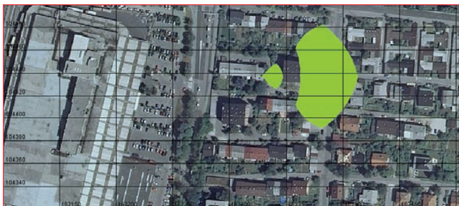
Slika 45: Vplivno območje radioamaterske postaje oddajne moči 1500 W na višini 35 metrov.
