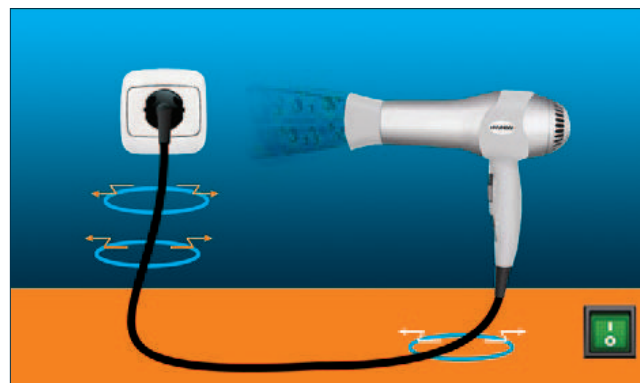
Slika 5: Ko sušilnik vključimo, steče električni tok, ki ustvari magnetno polje. Električno polje, ki je posledica električne napetosti (230 V), je stabilno. Magnetno polje pa se časovno spreminja, saj je posledica porabe - trenutnega električnega toka.
