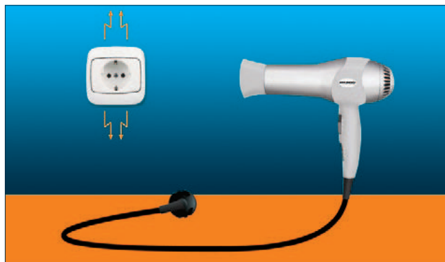
Slika 3: Električno polje se ustvari tam, kjer je prisotna električna napetost. V stanovanju imamo napetost 230 V na vtičnici, ki na razdalji 30 cm lahko povzroči električno poljsko jakost 5 V/m.
