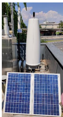
Slika 9: Izvajanje trajnih meritev VF EMS. Levo: Namestitev avtomatskega merilnega sistema, ki trajno meri VF EMS po posameznih tehnologijah oziroma frekvenčnih območjih. Desno: Rezultati trajnih meritev, izvedenih v Ljubljani v avgustu 2020. Predstavljene so skupne vrednosti v frekvenčnem območju od 100 kHz do 7 GHz ter prispevki baznih postaj 900 MHz, 1800 MHz in 2100 MHz. Iz meritev je razvidno značilno dnevno nihanje vrednosti VF EMS.
